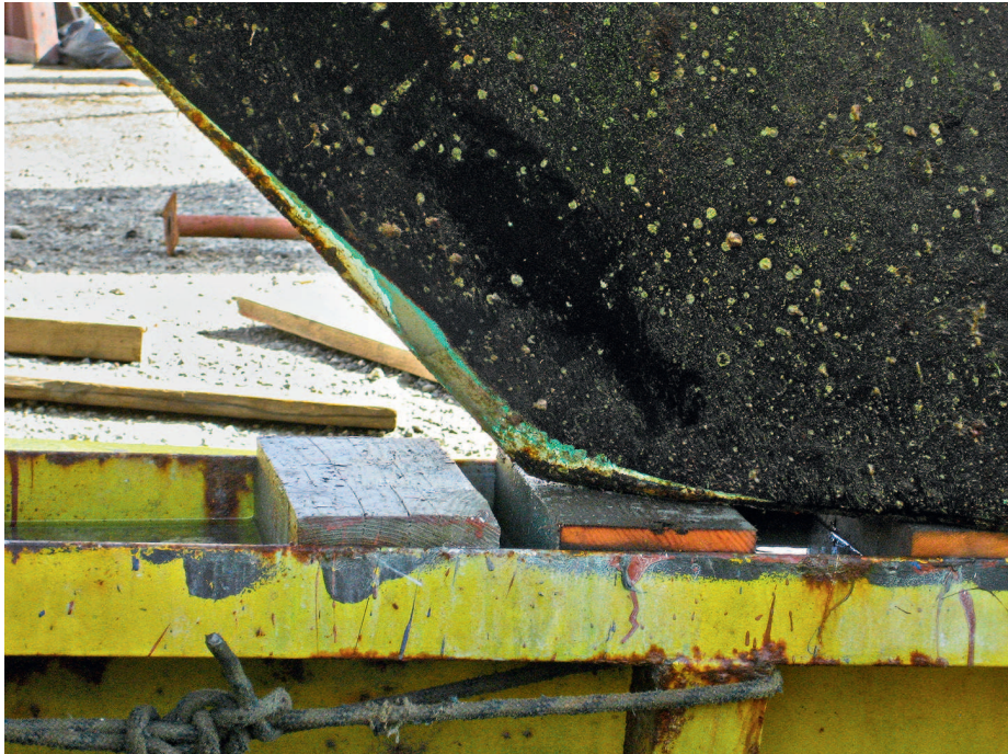
Frontal-Zusammenstoß an der tiefsten Stelle: Auf gut einem Meter Länge hat die raue Walhaut das Antifouling und Epoxy am Kiel abgeschabt
